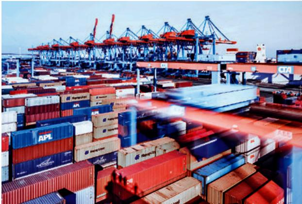
Lagerkräne bedienen das Blocklager des CTA.
