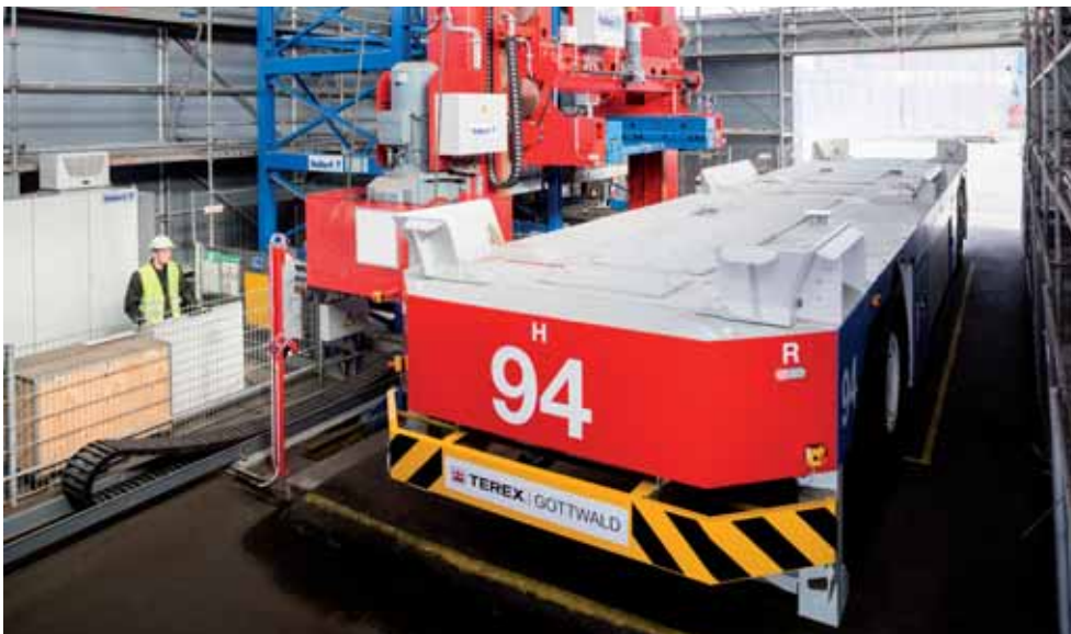
Die vollautomatische Batterie-wechselstation lädt mit Strom aus erneuerbaren Energien
