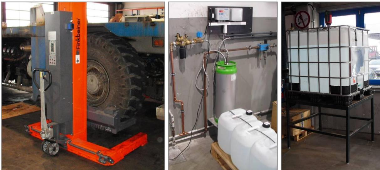
Abbildung 44: Mobile Radgreiferanlage und Batteriewasserentsalzungsanlage als Werkstattausrüstung für Batteriewartung
