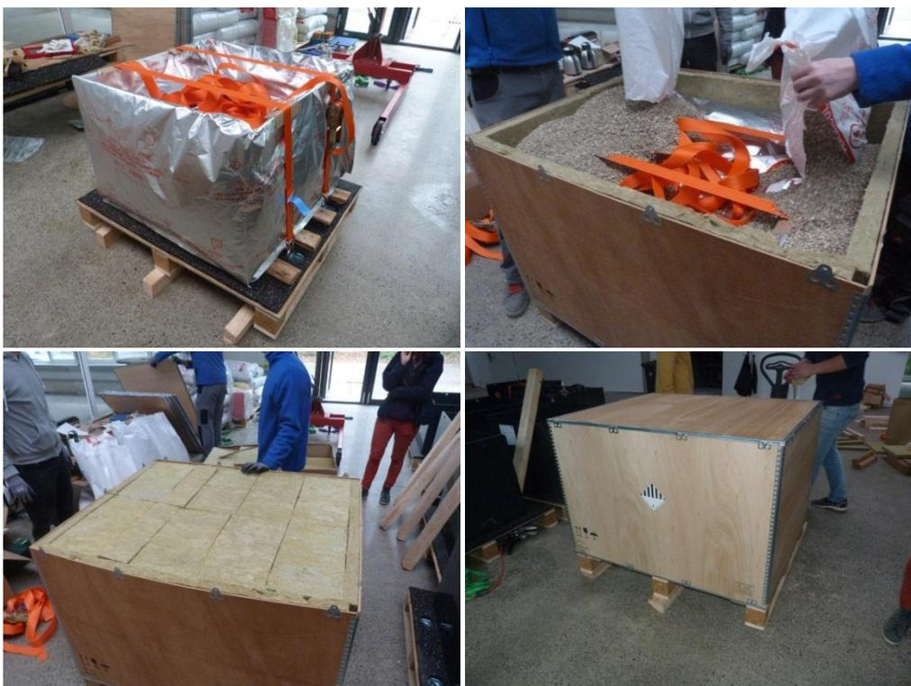
Abbildung 84: Transportverpackung eines Trogs für ein Typ 2-Batteriesystemmodul
