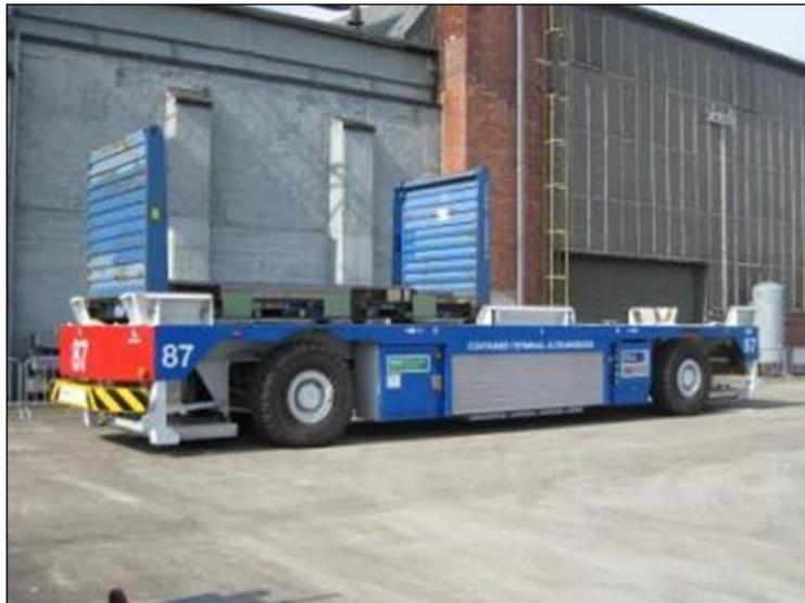
Abbildung 92: AGV-87 mit Testgewicht auf dem Testfeld von TEREX in Düsseldorf
