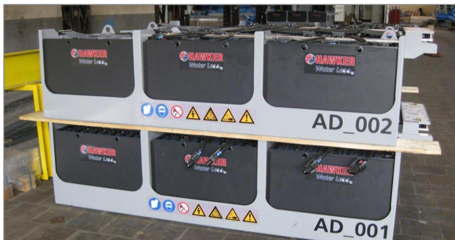
Abbildung 35: Zwei fertig aufgebaute Wechselbatterien
