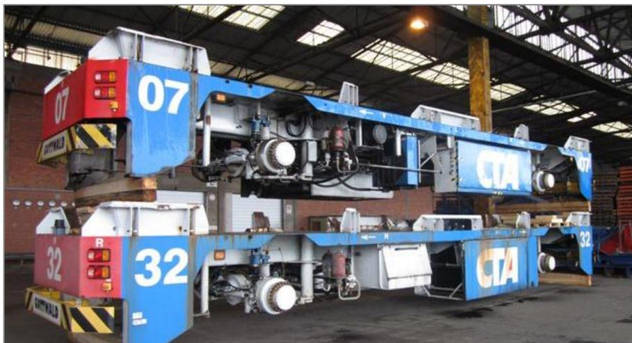
Abbildung 34: Chassis von Containertransportern mit diesel-hydraulischem Antriebsstrang, die auf Stapelholz gelagert worden sind
