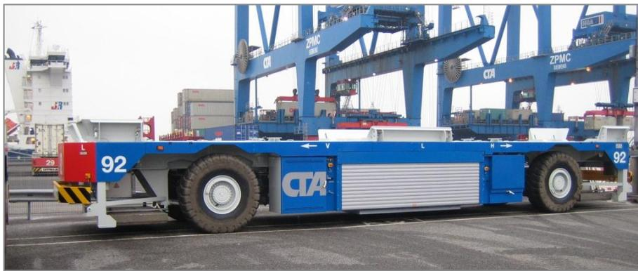
Abbildung 37: Containertransporter mit batterie-elektrischem Antriebsstrang bei Inbetriebnahme auf dem Terminalgelände
